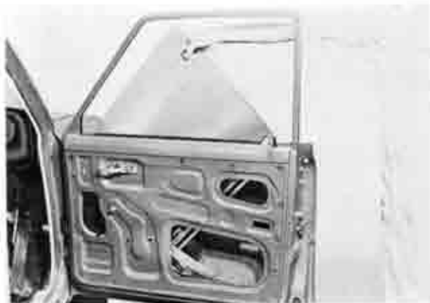
Fig. 14-21 Installing door glass
