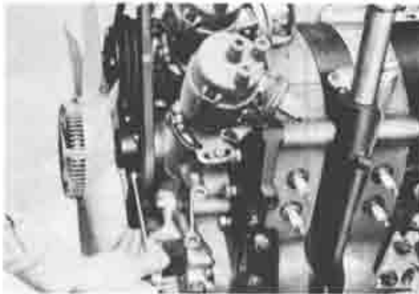
Fig. 1-15 Removing cooling fan
