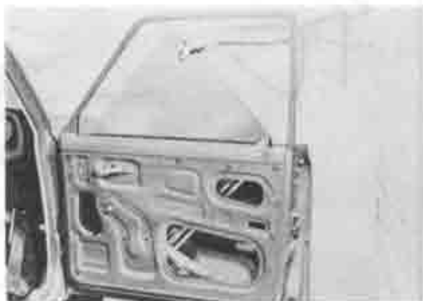
Fig. 14-21 Installing door glass
