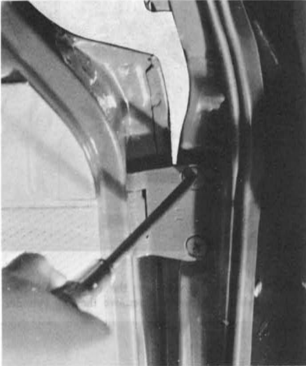
Fig. 14-10 Adjusting door hinge
