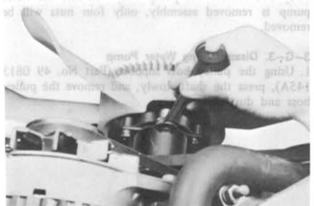
Fig. 3-8 Removing fan drive
