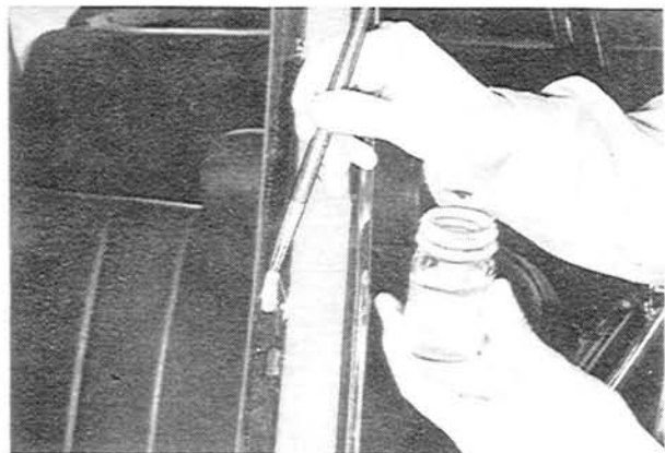
Fig. 14-8 Applying of primer
