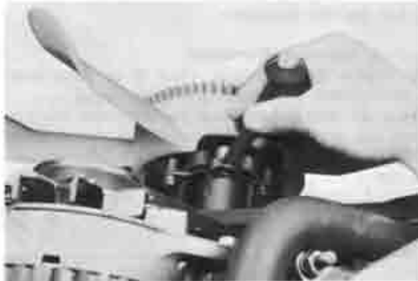
Fig. 3-13 Removing fan drive
