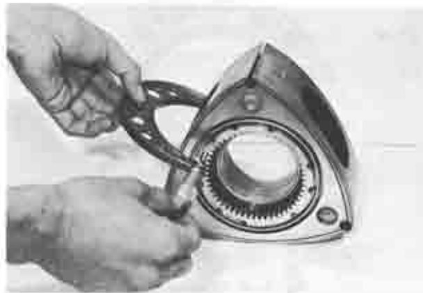
Fig. 1-37 Checking rotor width
