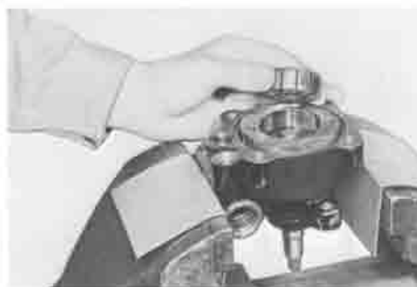
Fig. 10A-37 Installing rotor
