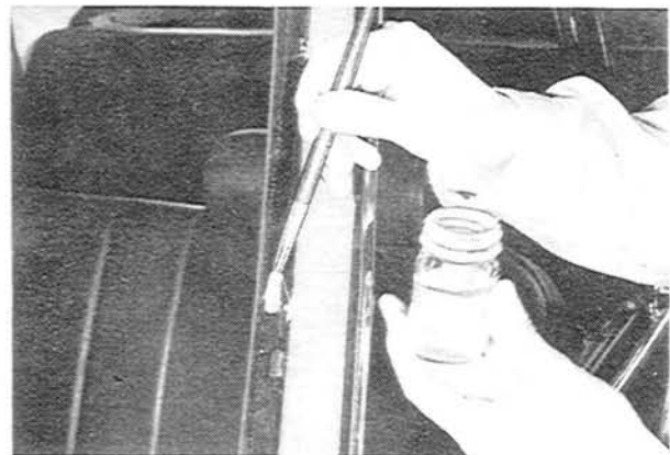
Fig. 14-8 Applying of primer
